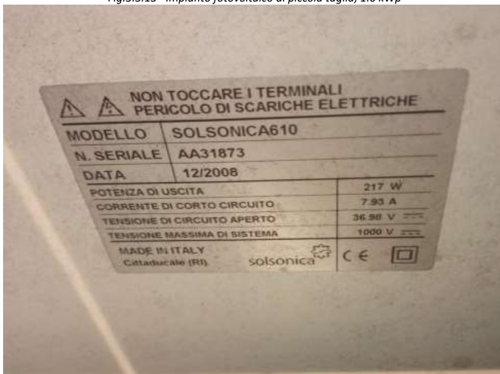
Fig.3.3.14 – Dati di targa dei pannelli fotovoltaici
