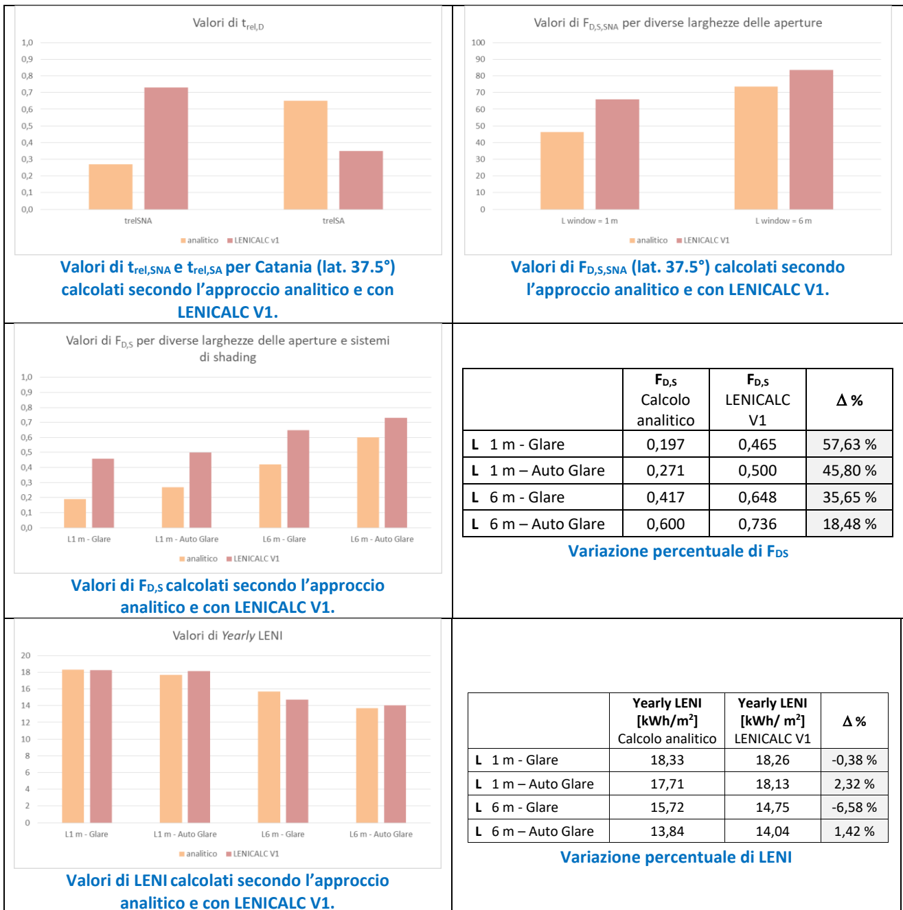
Figura 9: Confronto tra i dati di t_{rel,D} , F_{D,S,SNA} , F_{D,S} e LENI calcolati con approccio analitico e con LENICALC V1 per un ambiente posto a Catania al variare delle dimensioni della finestra e del tipo di sistema di schermatura
