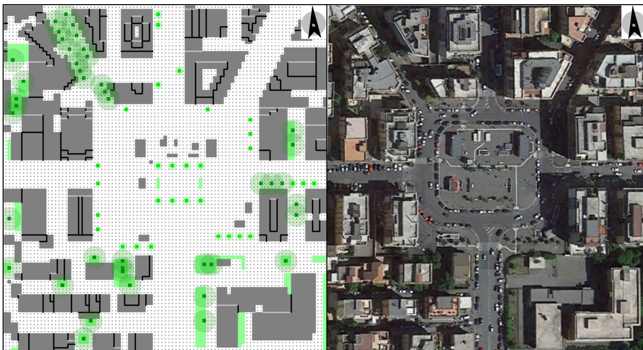
Figura 10: Geometria del modello numerico realizzato in ENVI-met e immagine satellitare di Piazza dei Mirti.
