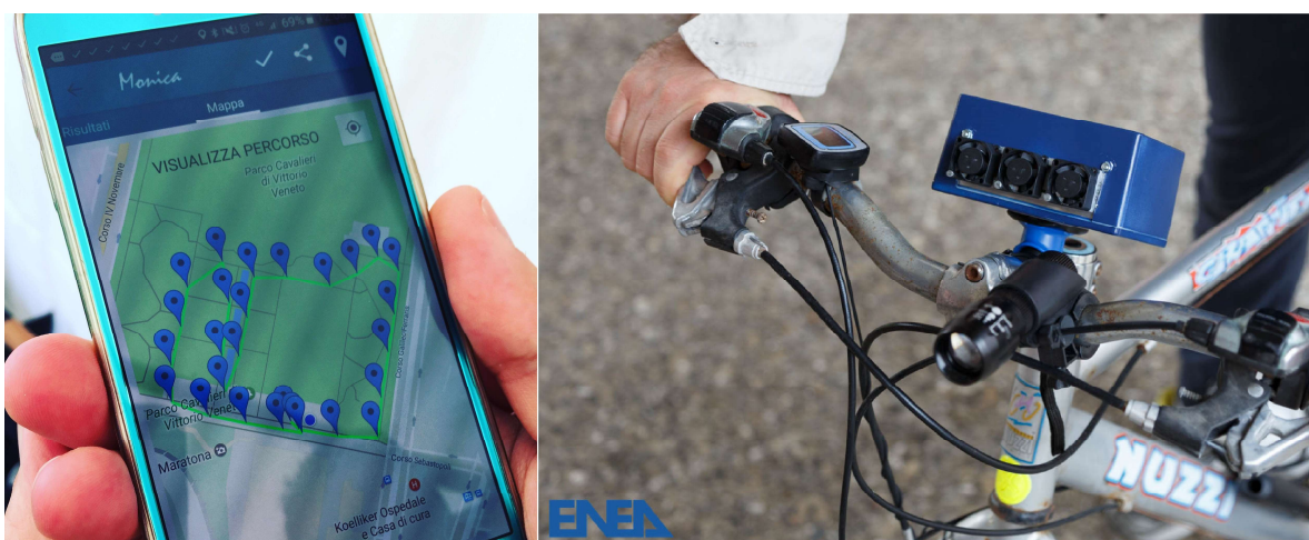
Figura 16. Il sistema Monica: a sx l'interfaccia su smartphone, a dx un prototipo su bicicletta
