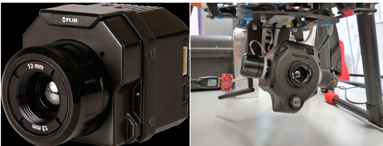
Figura 1. La termo camera FLIR VUE Pro R (sx) ed il sensore Panoptes (dx): una termocamera sovrapposta ad una videocamera HD, montate su supporto cardanico
