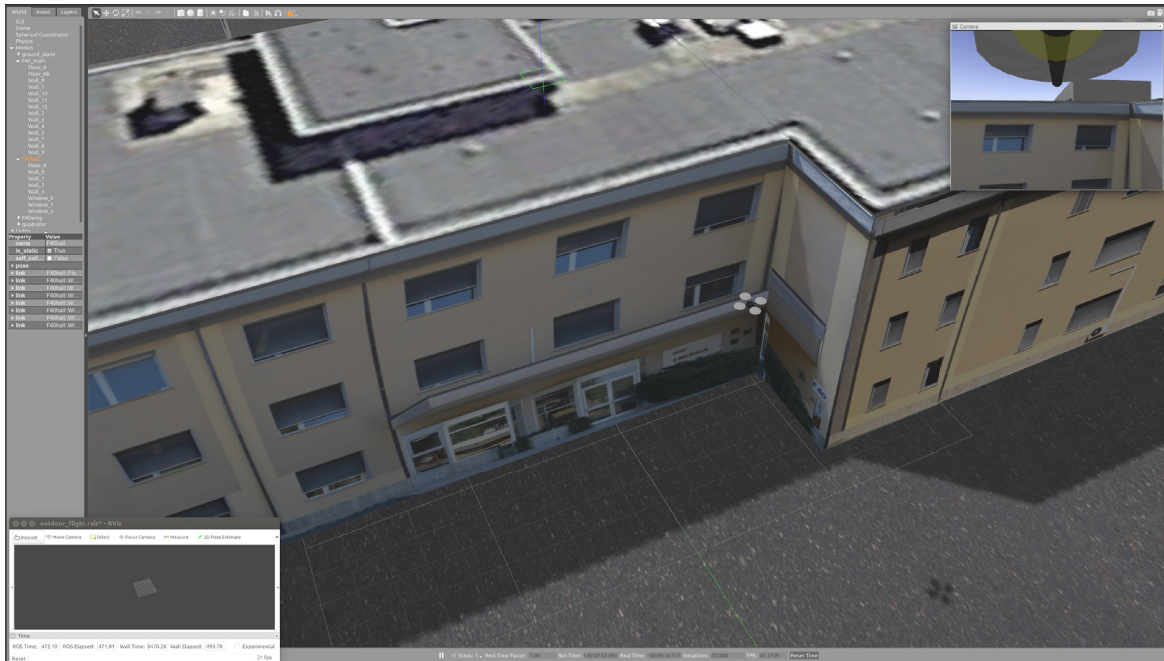
Figura 8. Il drone simulato in volo attorno all'edificio di test, a sinistra una finestra per il controllo dei dati e a destra l'immagine ripresa dalla telecamera di bordo
