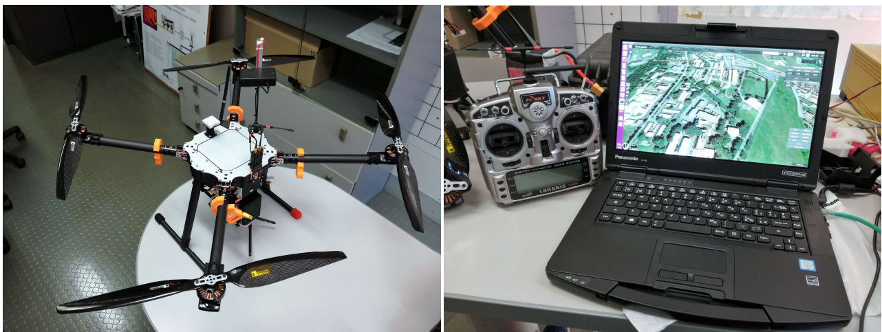
Figura 3. Il drone quadri elica (sx) e la sua stazione di terra (dx)
