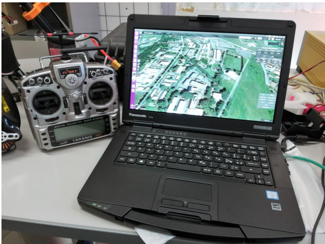
Figura 2. La stazione di terra composta da un PC e da un radiocomando
