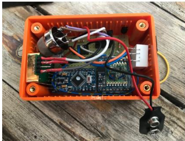
Figura 88 Il sistema multi-sensore assemblato nella versione pre-prototipale
