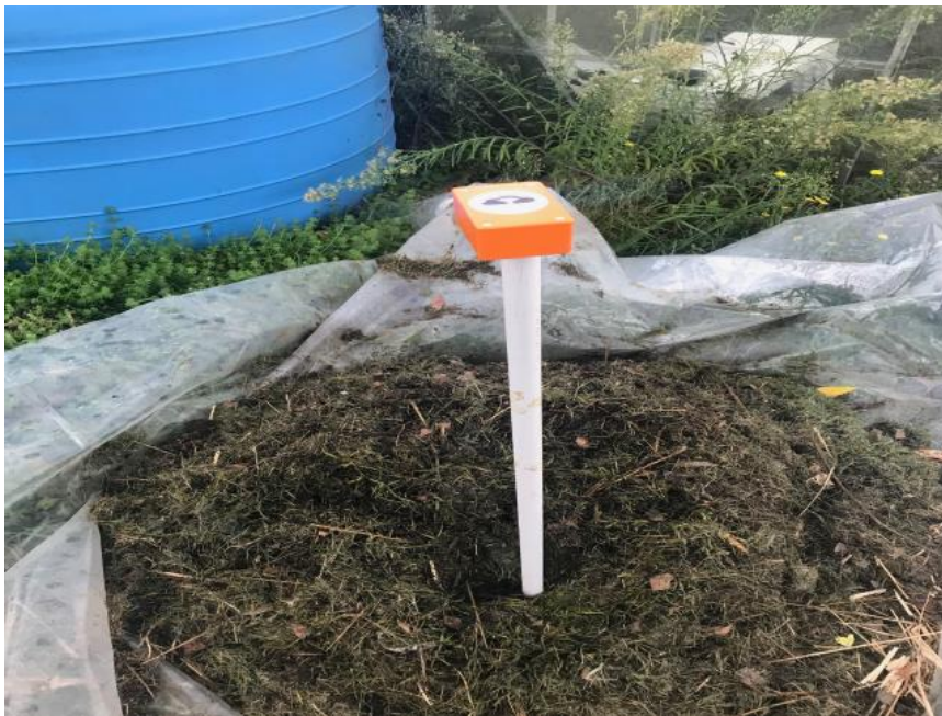
Figura 89 Sistema multi-sensore collocato su asta cava inserita nel cumulo
