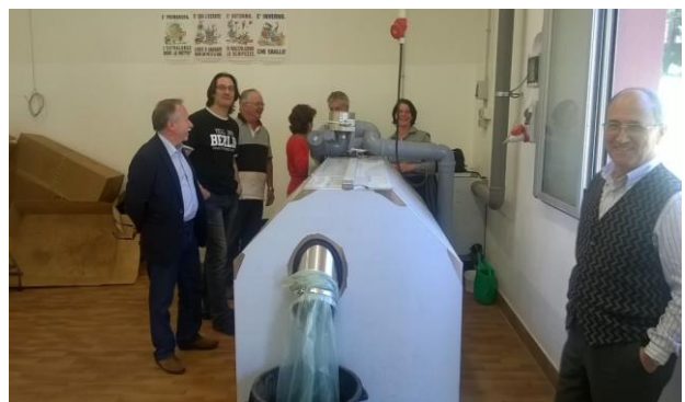
Figura 80 Composter Big Hanna T60 installato presso l'Enea Casaccia
