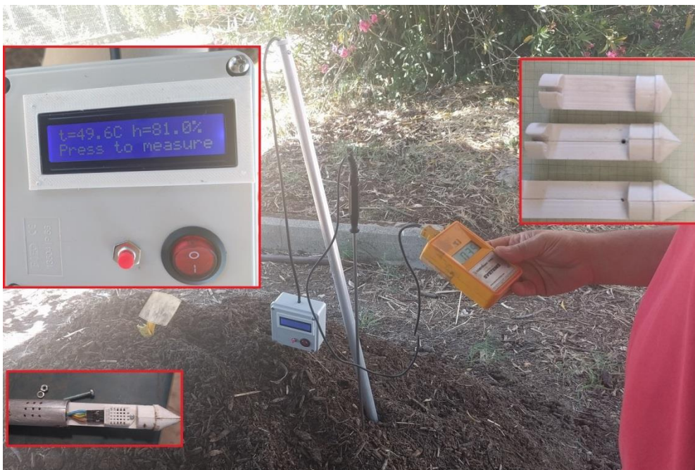
Figura 86 Test di un sensore (DHT22 per umidità e temperatura, meno di 3 euro) e studio della forma ottimale delle punte.
