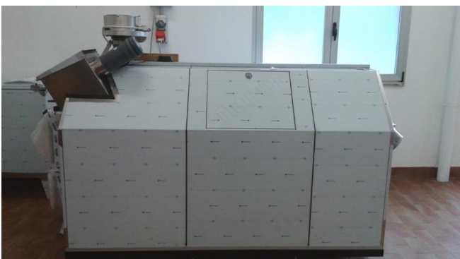
Figura 80 Composter Big Hanna T60 installato presso l'Enea Casaccia
