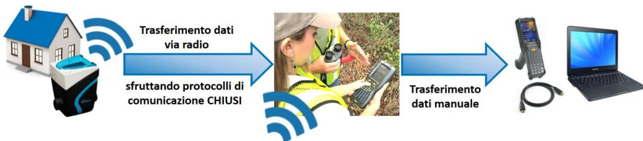
Figura 14. Architettura RMR in modalità walk-by .
