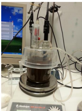
Figura 7. Il respirometro in fase di ripristino della condizione endogena
