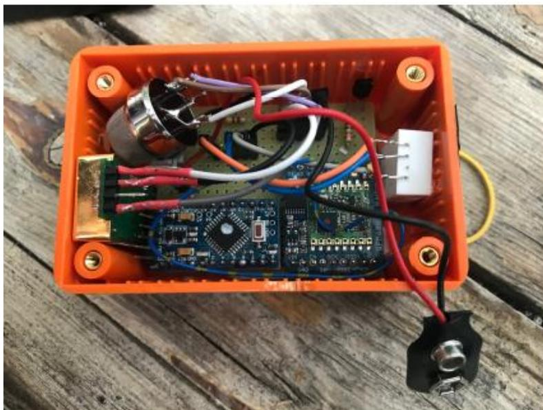
**FIGURA 2.** Il sistema multi-sensore assemblato nella versione pre-prototipale
