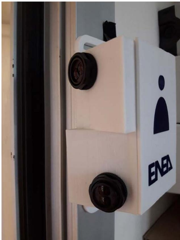
Figura 3-Sensore conta persone installato in un ufficio del Centro Enea della Casaccia
