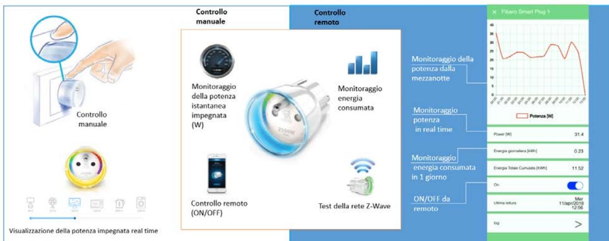
Figura 11-Smart plug: funzionamento ed interfaccia
