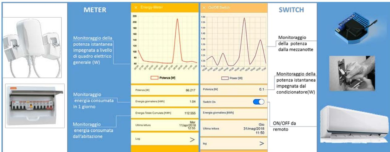
Figura 10-Smart Meter e Switch: funzionamento ed interfaccia utente
