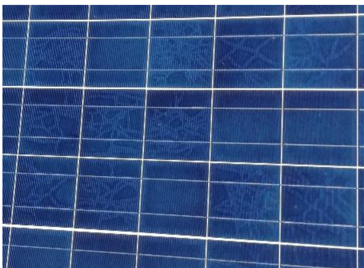
Fig. 3.1.7 - Campione di pannello con effetto “bava di lumaca”
