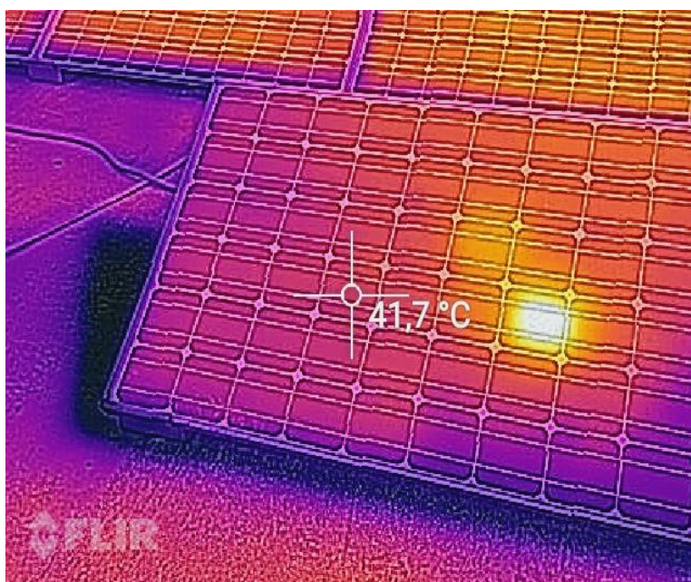
Fig.3.4.6 - Temperatura delle celle non danneggiate
