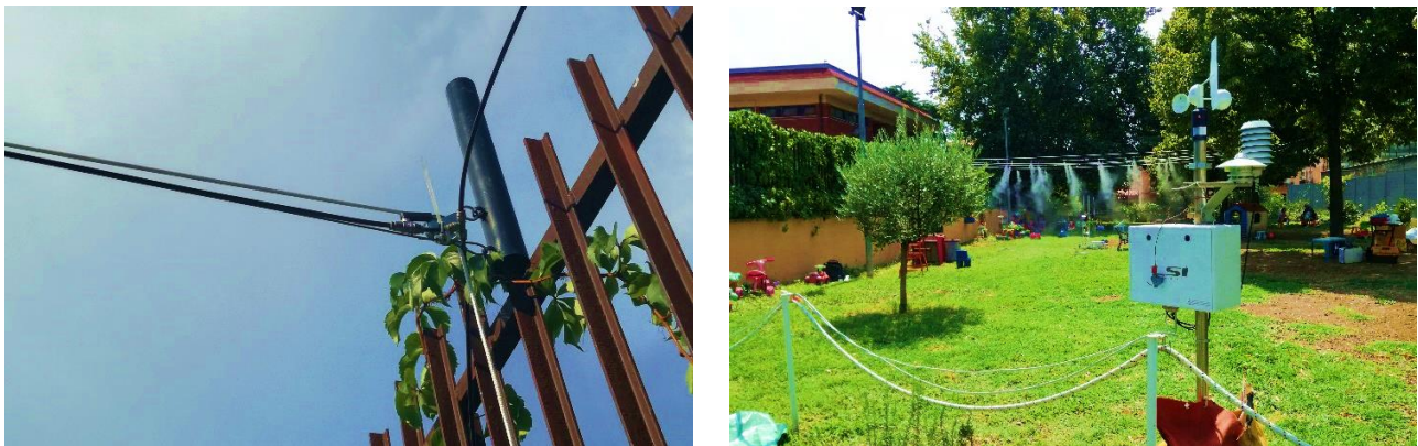
Figura 8. Setup sperimentale a Centocelle. In ordine dall'alto a sinistra verso il basso a destra: panoramica del sistema nebulizzante, dettaglio delle carrucole e degli agganci ad albero, dettaglio del cilindro a doppio occhio sulla ringhiera in ferro, dettaglio del posizionamento della stazione meteo rispetto ai filari nebulizzanti.
