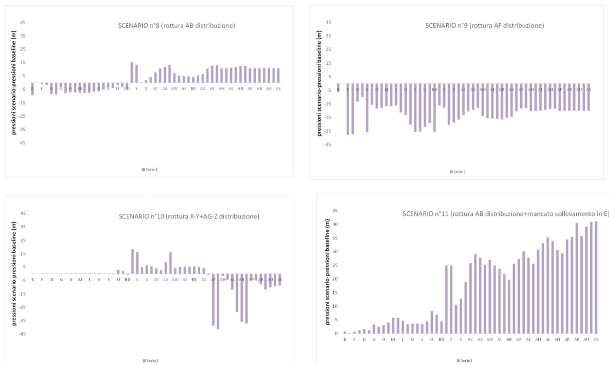
Figura 18. Confronto tra le distribuzioni delle pressioni nodali dello scenario baseline e gli scenari 8-11 relativi alla rete di distribuzione
