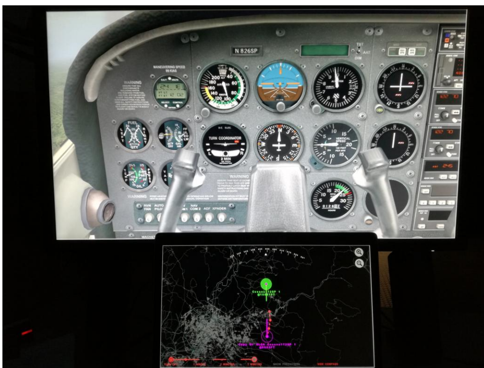
Figura 10. Il sistema OLGA: in alto la simulazione del volo di un Cessna, in basso lo strumento OLGA dove è visibile in alto un aereo (in verde) in rotta di collisione ed il suggerimento di rotta in rosso
