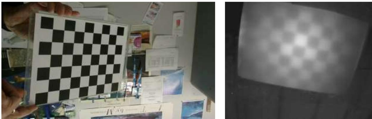
**Figura 15. Il medesimo pattern di calibrazione nella banda visibile e nell’infrarosso termico**
