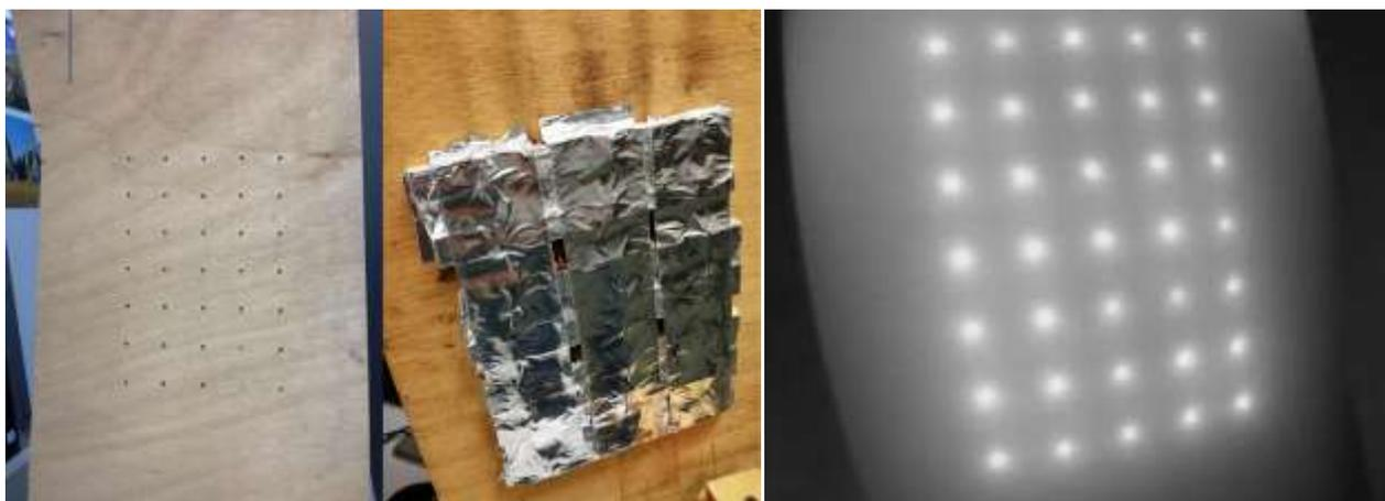
**Figura 16. Il pattern termico realizzato (fronte e retro) e l'immagine termica del pattern**
