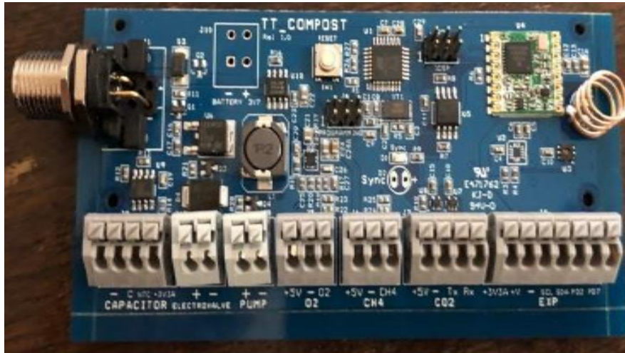
Figura 124: PCB del Compost Talker™ 2.0: schema grafico e foto della piastra
