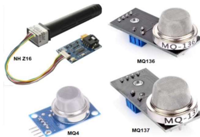
Figura 119: Sensori adottati per la concentrazione dei gas in emissione
