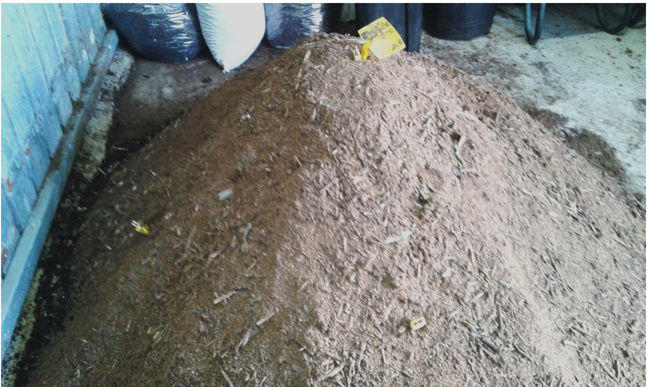
Figura 100: Cumulo in maturazione; visibili termocoppie centrale e laterali (color giallo)
