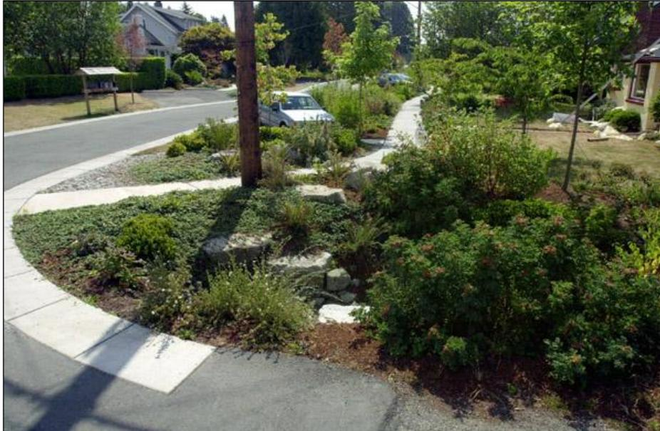
Figura 5.10: Esempio di Bioretention in un giardino privato [<http://www.water-research.net>]
