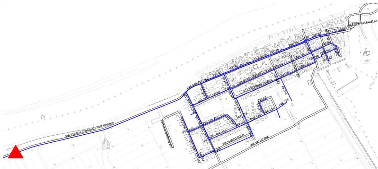
**Figura 7. Schema idraulico del distretto di Gorino Ferrarese (triangolo rosso: misuratore di distretto; linee blu: rete di distribuzione).**
