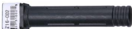
Figura 2. Sensore ottico all'infrarosso MHZ-16 con range 0-50000 ppm ed uscita seriale ed alimentazione a 5V
