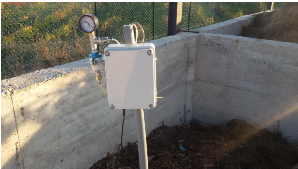
Figura 15. Particolare del sistema di misura Compost Talker™ in funzione sul cumulo
