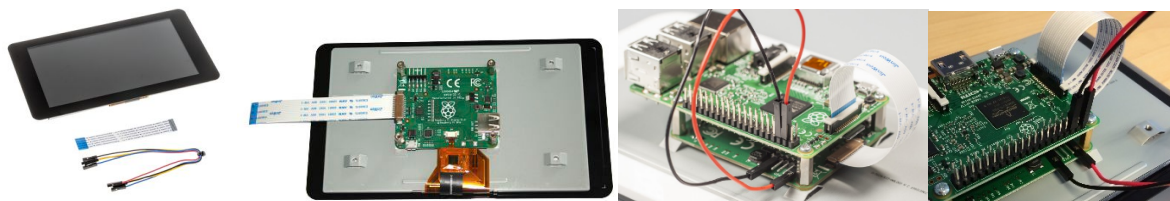
Figura 2: Touch screen (installazione su raspberry)
