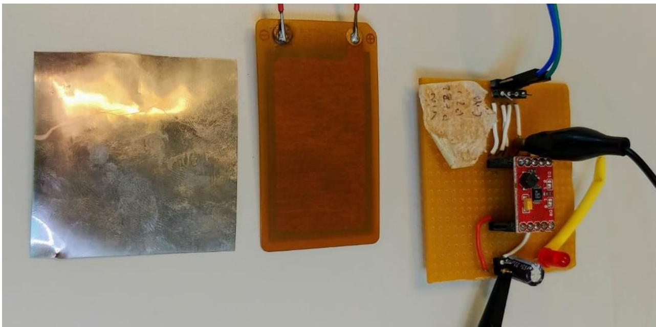
Figura 2.2 – Da sinistra a destra: cella in PVDF, cella DuraAct e sistema basato sul LTC3588 per l’energy harvesting
