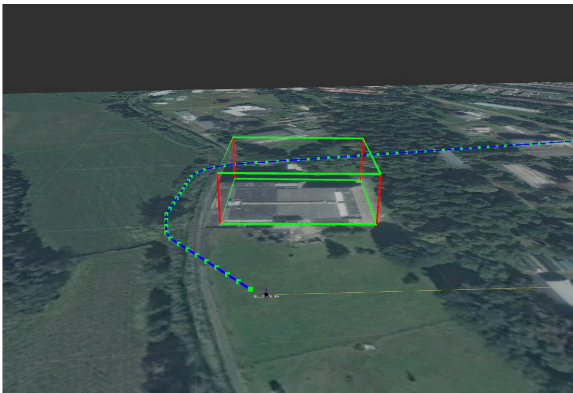
Figura 6. Esempio del display fornito dall' algoritmo: la mappa, l'edificio con il suo ingombro, la traiettoria suggerita
