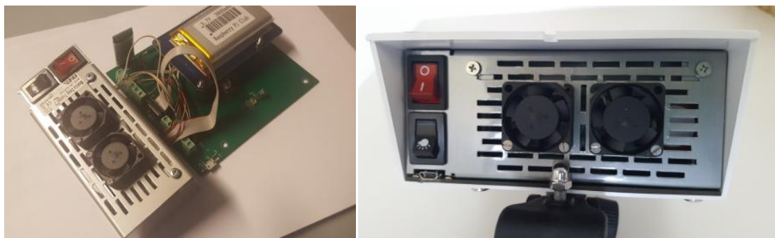
Figura 9. Versione del dispositivo Monica con housing sensori metallico
