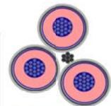
Cavo con isolamento in gomma etilenpropilenica
