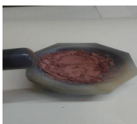
Fig 4 : Miscelazione in un mortaio ad agata dei campioni CaO/Ca 12 Al 14 O 33 al 50% in peso di CaO e Ca 12 Al 14 O 33 e Fe 2 O 3 . Successivamente veniva trasferita la miscela così mescolata in un crogiolo di ceramica e effettuato un trattamento in muffola a 900°C per 3 ore in aria ad una velocità di riscaldamento di 10°C/min.
