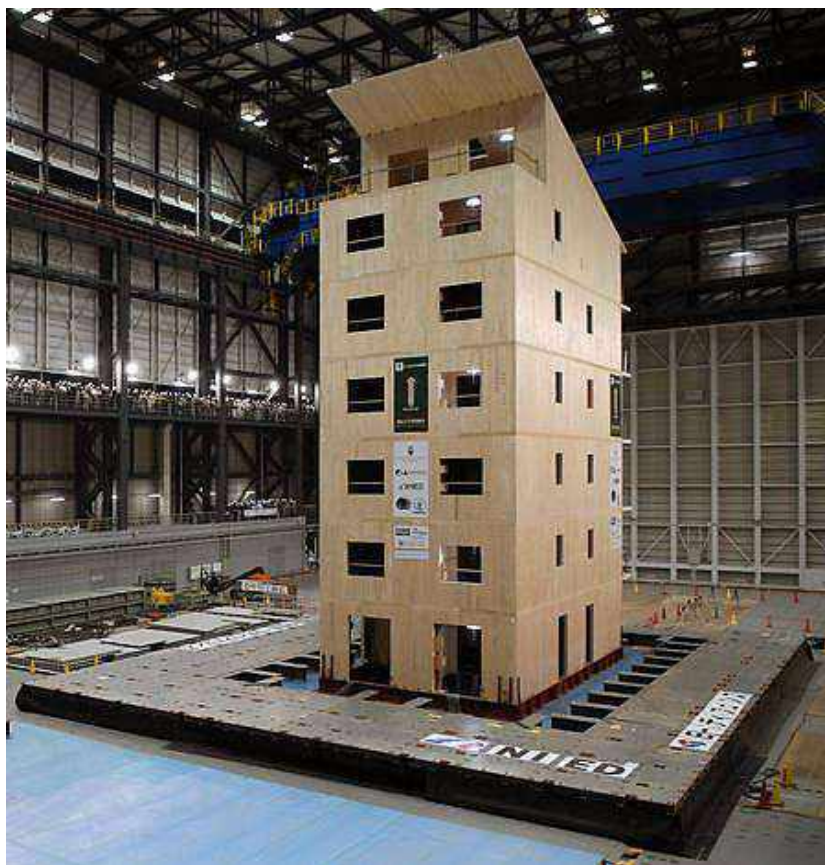
Figura 127. Progetto SOFIE - test sismico 2007. Foto © Romano Magrone
