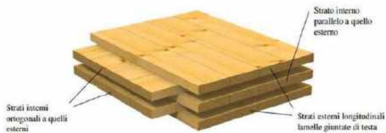
Figura 126. Schema di un pannello in X-LAM
