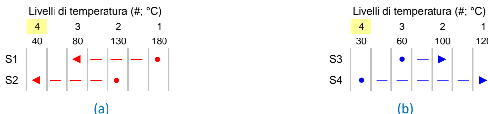
Figura 25. Intervalli di temperatura delle curve cumulative dei fluidi caldi (a) e freddi (b)
