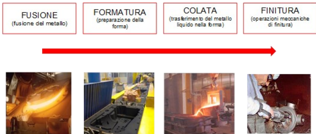
Figura 9 - Le principali fasi del processo di fonderia con formatura "a perdere" in sabbia
