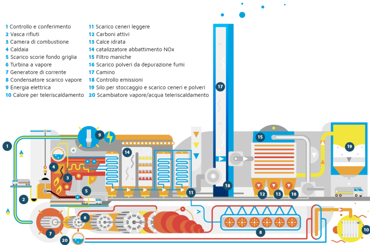
Figura 38 - Schematizzazione del processo di incenerimento dei rifiuti.
