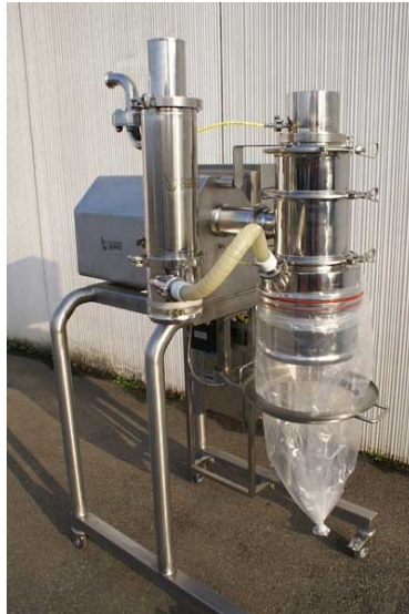
Figura 3.6: esempio di mulino di macinazione per l'industria farmaceutica
