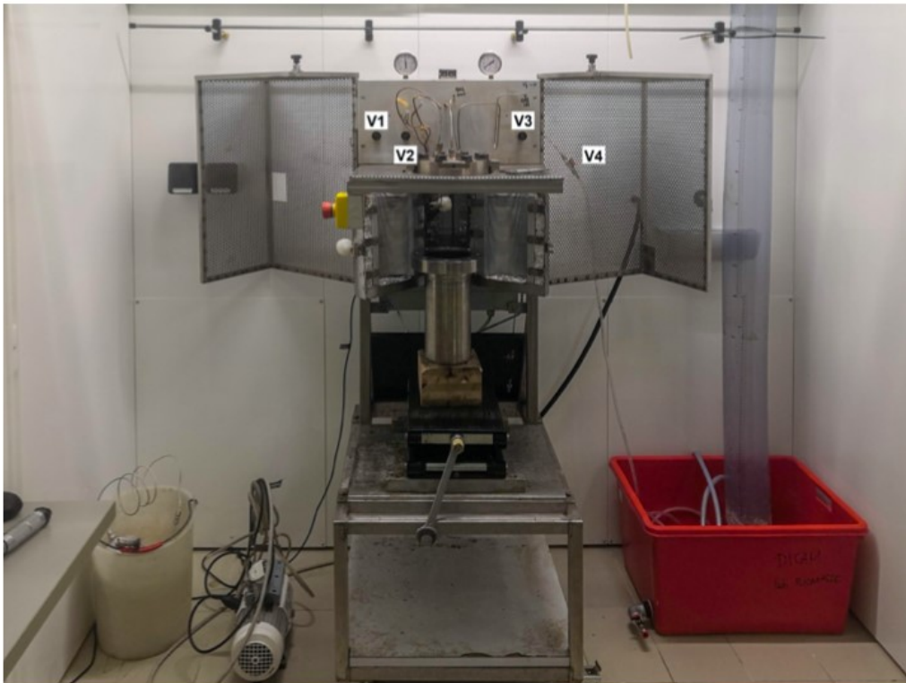
Figura 3. Sistema sperimentale di carbonizzazione idrotermica
