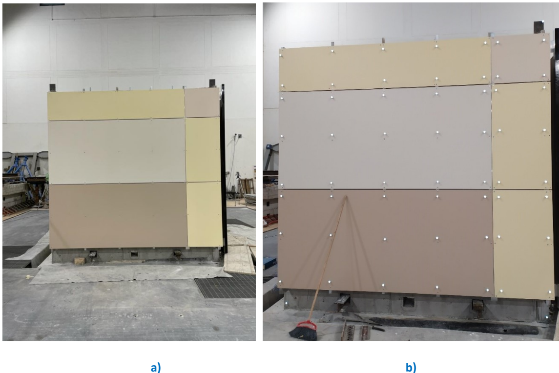
Figura 262. Parete est: vista della parete finita (a) e dei markers utilizzati per le prove (b)
