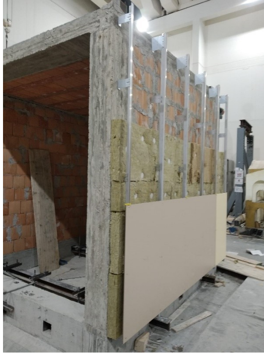
Figura 260. Parete est: installazione dei pannelli in HPL
