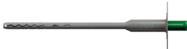
Figura 25. Fissaggio ISOX-S: Tassello in polipropilene testa Ø60 - Chiodo premontato in acciaio con testa in polipropilene
