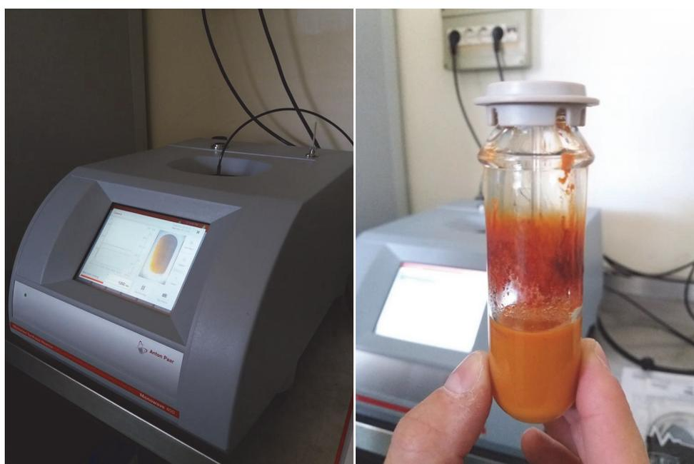
Figura 27. Reattore a microonde e prodotto post-sintesi.
