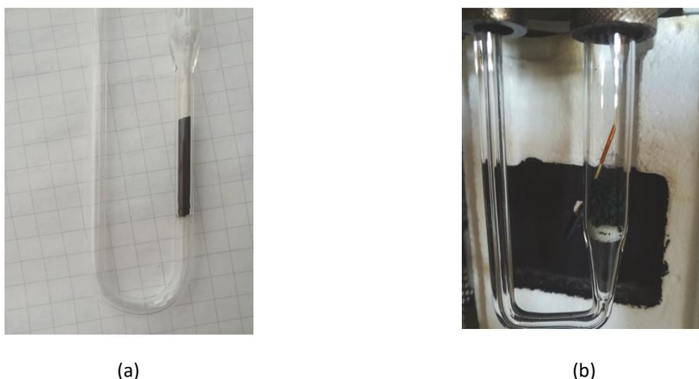
**Figura 39. Immagine dei reattori in vetro utilizzati per le misure di adsorbimento/desorbimento in flusso caricati con polvere di materiale composito magnetico (MFC) (a) o granuli (b). Il materiale è adagiato su di un fritto in vetro.**
