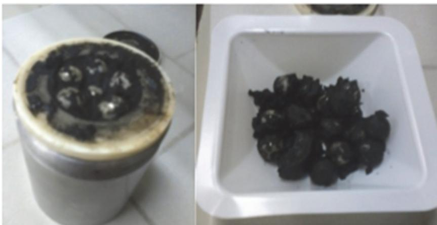
**Figura 10. Immagini della magnetite prodotta prima della purificazione.**
