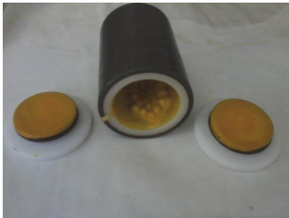
Figura 28. Prodotto della reazione dopo 1h di milling.
