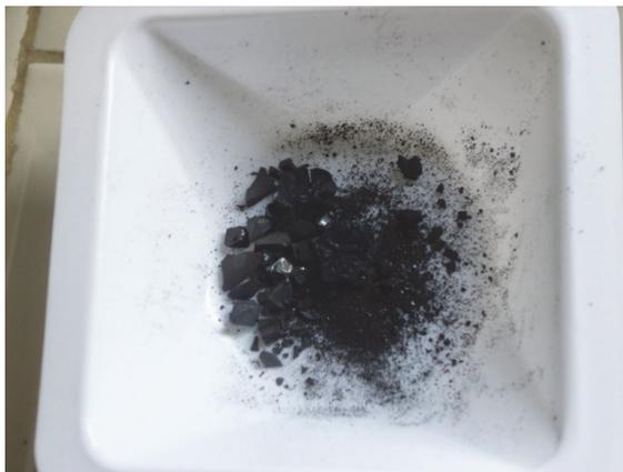
**Figura 11. Polvere recuperata dopo 1h di macinazione e successiva purificazione ed essiccazione.**
