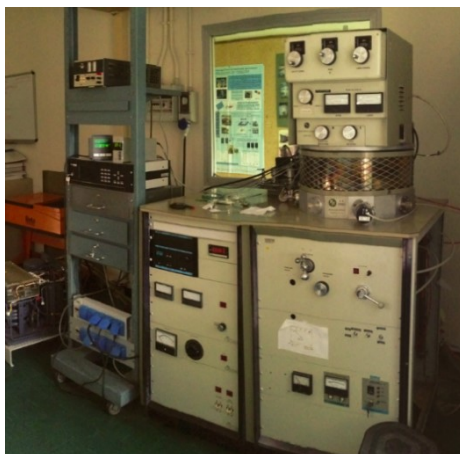
Figura 3 - 14 Impianto di sputtering MRC 8626 utilizzato per la crescita di film di Ce_{0.8}Sm_{0.2}O_{2-6} .
