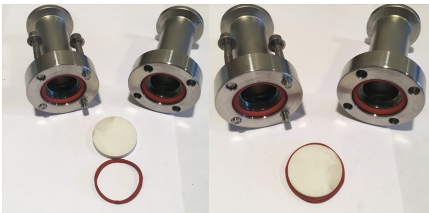
Figura 4 - 21 Camera di misura.
