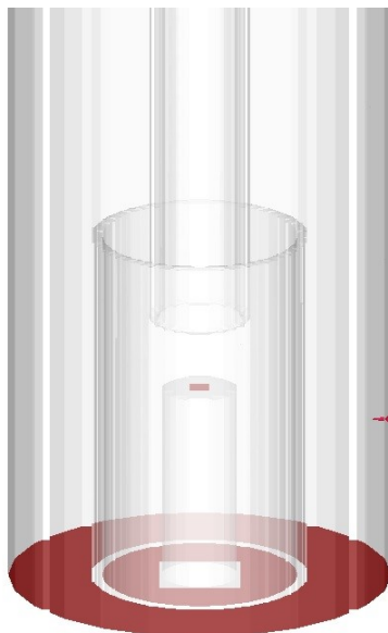
Figura 17 – Dettaglio del dominio i calcolo della Geometria 2 , con tubo “camicia” e ugello rialzato. Le superfici in rosso sono quelle di ingresso del gas, la freccia laterale indica l’ingresso delle particelle solide
