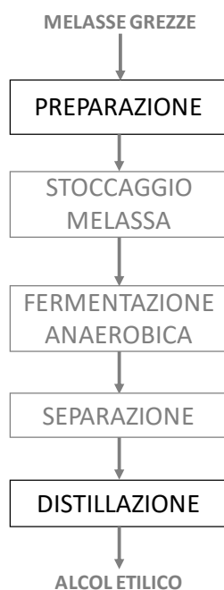
Figura 54. Schema di processo “tipo” di produzione dell’alcol etilico definito nell’ambito del presente progetto
