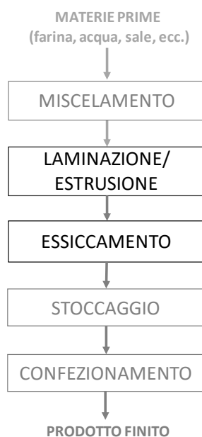
Figura 48. Schema di processo “tipo” di produzione di pasta essiccata definito nell’ambito del presente progetto
