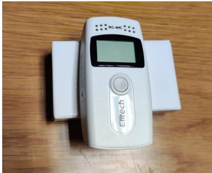
Figura 56: Misuratore di temperatura Elitech RC-4HC
