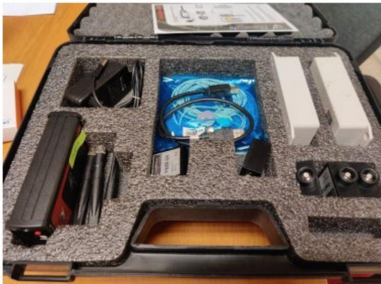
Figura 50: termoflussimetro ThermoZig
