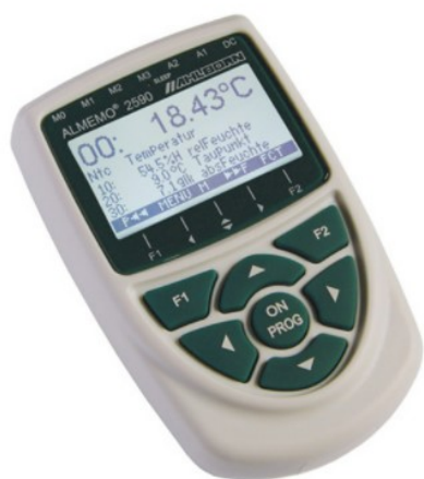
Figura 36 Termoflussimetro modello ALMEMO 2590 - 4S
