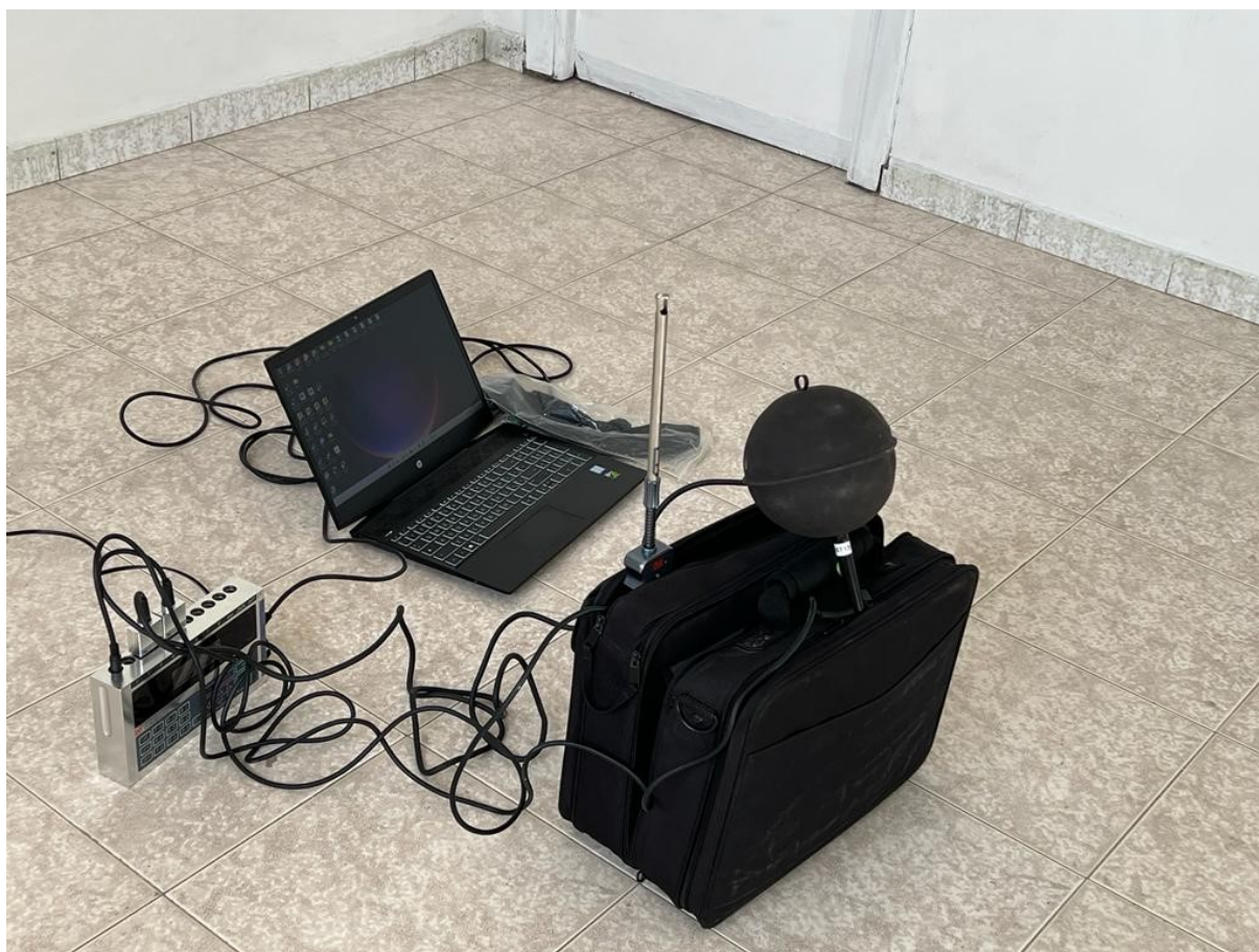
Figura 37 Centralina microclimatica BABUC
