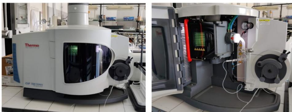
Figura 1. ICP-OES utilizzato per condurre le analisi. A destra, la copertura è stata aperta per mostrare il sistema di introduzione del campione (nebulizzatore e camera di nebulizzazione), la pompa peristaltica e la base della torcia, dove si ha l'ingresso nell'argon. In entrambe le fotografie, lo strumento è in funzione (si può osservare la tipica colorazione verde dell'ICP).
