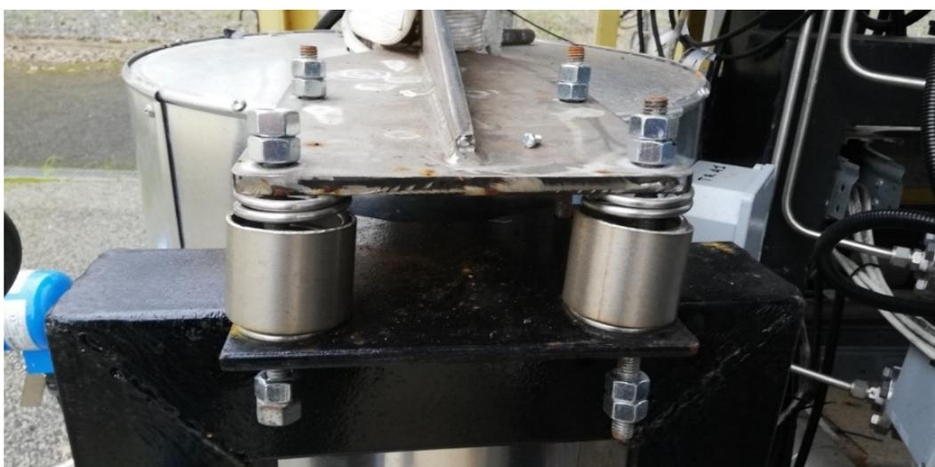
**Figura 20 (a) posizione del vincolo deformabile del calcinatore per compensazioni longitudinali; (b) installazione del vincolo del calcinatore**
