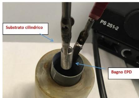
**Figura 67 Immagine del bagno per la deposizione delle polveri di  $\text{La}_{0.6}\text{Sr}_{0.4}\text{Fe}_{0.8}\text{Co}_{0.2}\text{O}_{3-\delta}$  su di un substrato cilindrico.**
