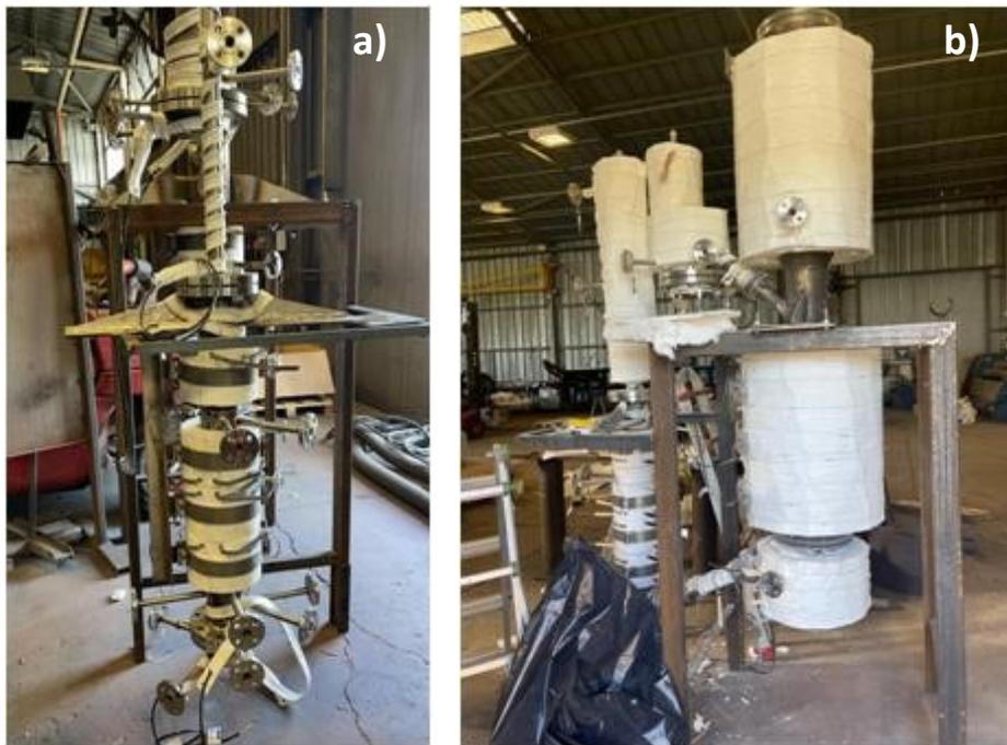
Figura 27 (a) posizionamento dei nastri riscaldatori e dei gusci scaldanti rispettivamente nella parte superiore del calcinatore (riser) e nella parte inferiore; (b) Montaggio del coibente su tutti i tratti del banco prova.
