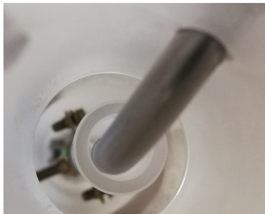
Figura 6 – Realizzazione del modello freddo in plexiglass – tubo ugello direzionato verso imbocco del tubo riser
