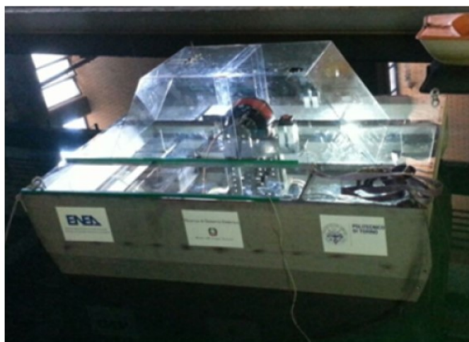
Figura 2 Prototipo 1:12 di PeWEC durante una prova sperimentale nella vasca idrodinamica di Roma INSEAN.
