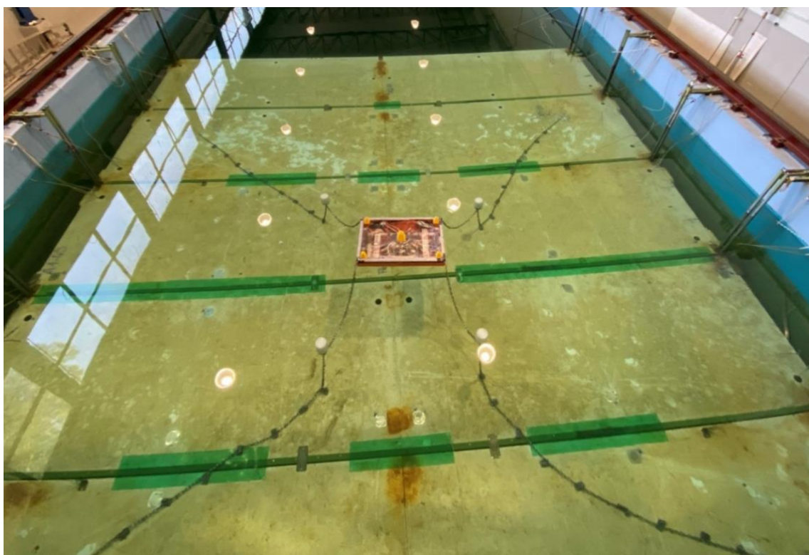
FIGURA 2.14. CONFIGURAZIONE ORMEGGIO A 0° IN VASCA NAVALE
