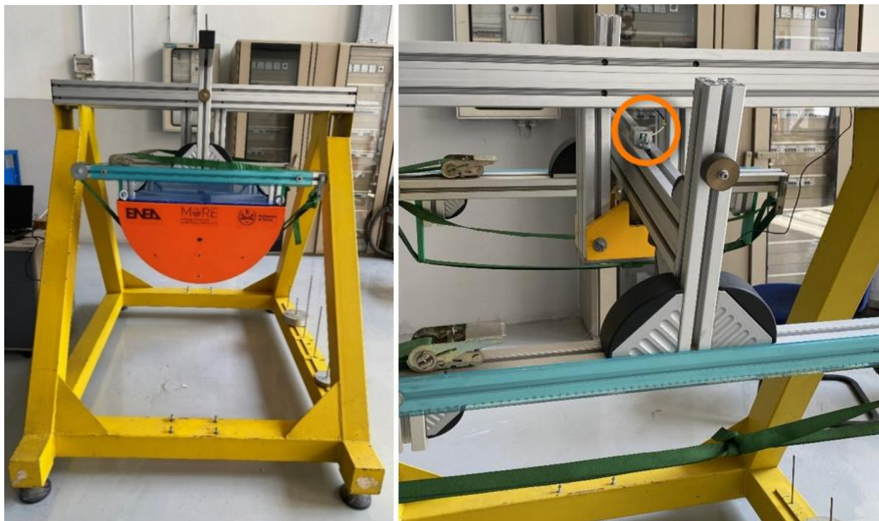
FIGURA 2.10. BILANCIA INERZIALE CON PROTOTIPO E POSIZIONAMENTO ACCELEROMETRO.
