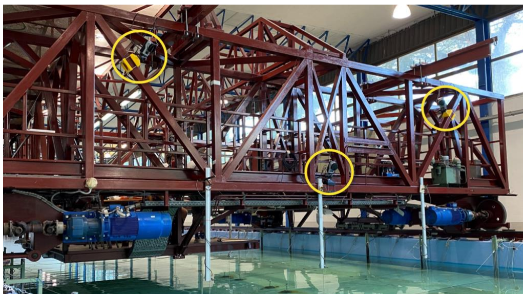
FIGURA 2.8. FOTO DEL POSIZIONAMENTO DEL SISTEMA QUALISYS SUL CARRO DINAMOMETRICO.
