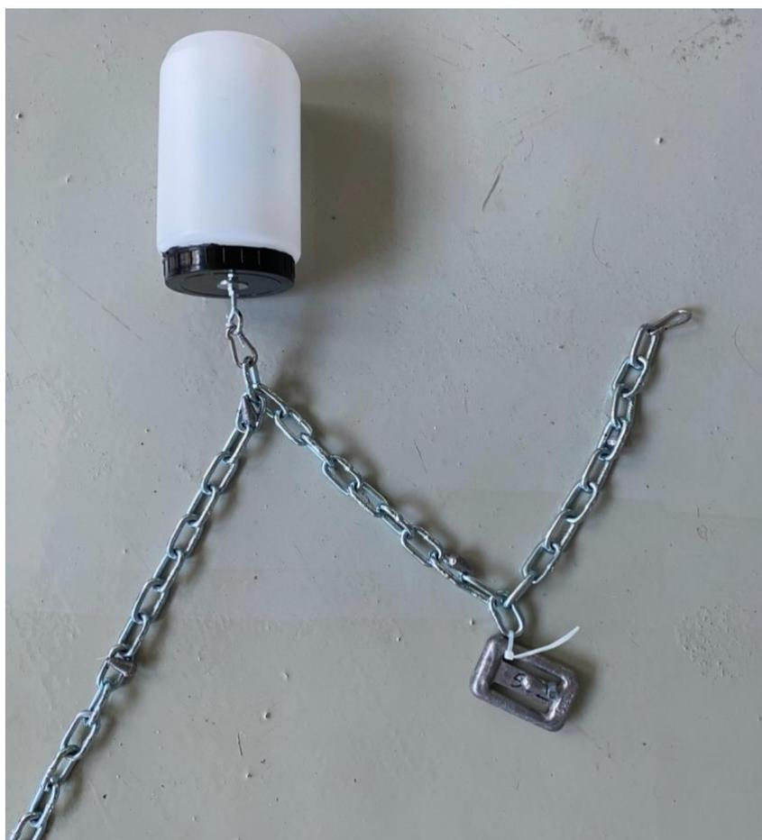
FIGURA 11 DETTAGLIO DEL GALLEGGIANTE DEL SISTEMA DI ORMEGGIO.
