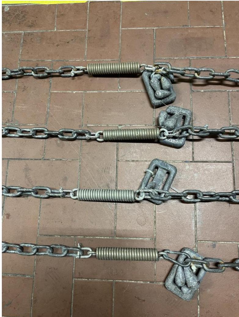
**FIGURA 10** DETTAGLIO DELLA LINEA DI ORMEGGIO. SI EVIDENZIA LA MOLLA ELICOIDALE MONTATA PER GARANTIRE LA CORRETTA SCALATURA DELLA RIGIDEZZA LINEARE DELLA LINEA DI ORMEGGIO.
