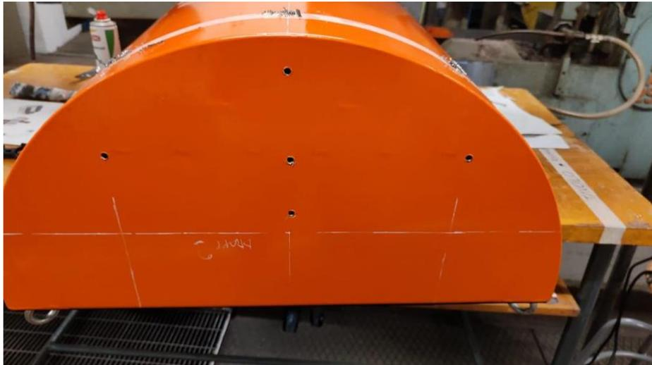
FIGURA 2 FORATURA DELLA CARENA DELLO SCAFO PER ALLOGGIO SENSORI DI PRESSIONE.
