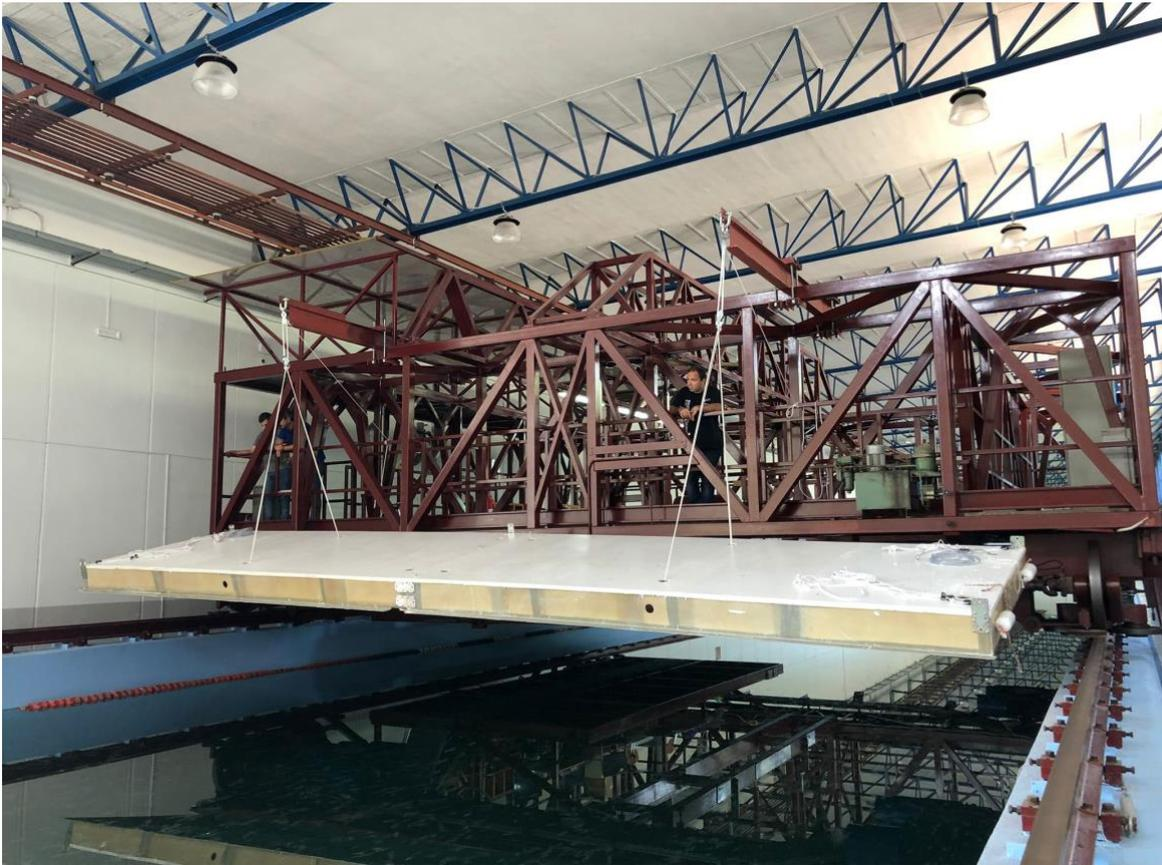
**FIGURA 12** INSTALLAZIONE DI UN PANNELLO DEL FONDALE ARTIFICIALE.
