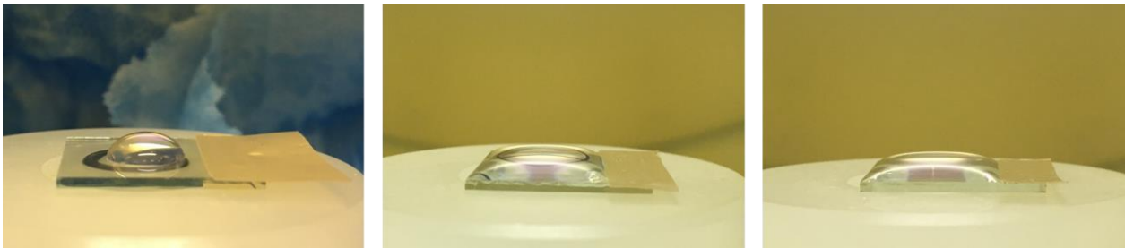
Figura 8: Substrato con soluzione di SnO 2 (1:1), da sinistra a destra: substrato senza trattamento UV-O 3 ; dopo 15 min di trattamento; dopo 30 min di trattamento
