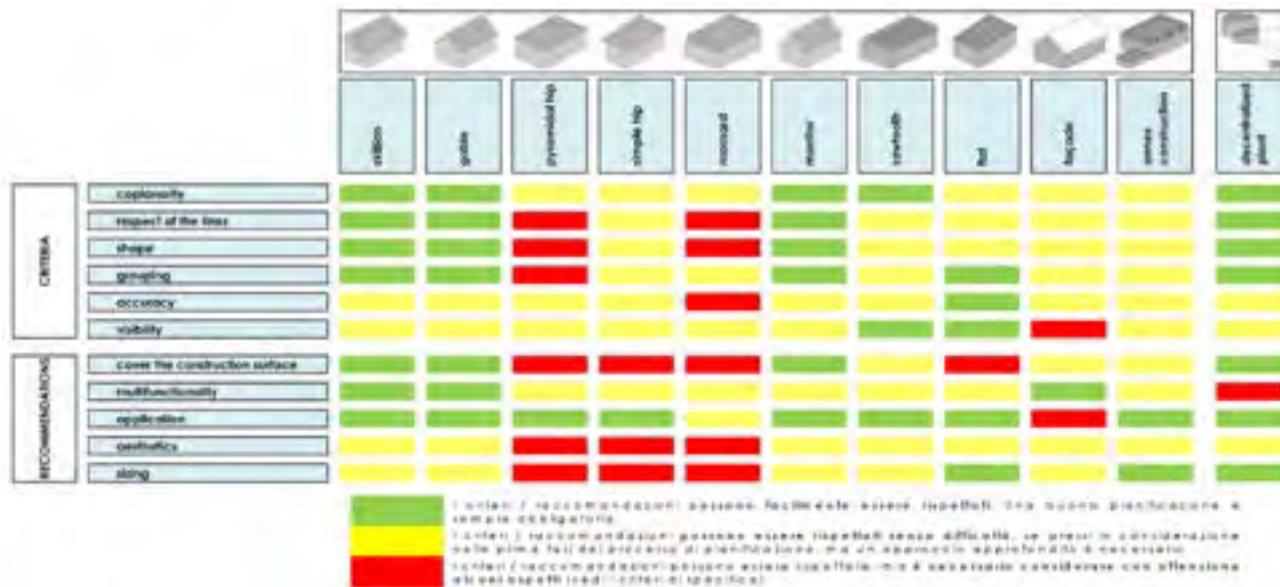
**Figura 6. Progetto SuRHiB. Quadro sinottico relativo alla compatibilità dei criteri e raccomandazioni con le diverse tipologie di involucro rilevate sul territorio ticinese [Fonte: SUPSI - ISAAC].**
