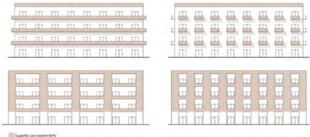
**Figura 49. Valutazione, a seconda della morfologia edilizia, delle aree idonee per integrazione di sistemi FV integrati. Valutazione dei possibili range di estensione di balconi (in alto) e di logge (in basso).**
