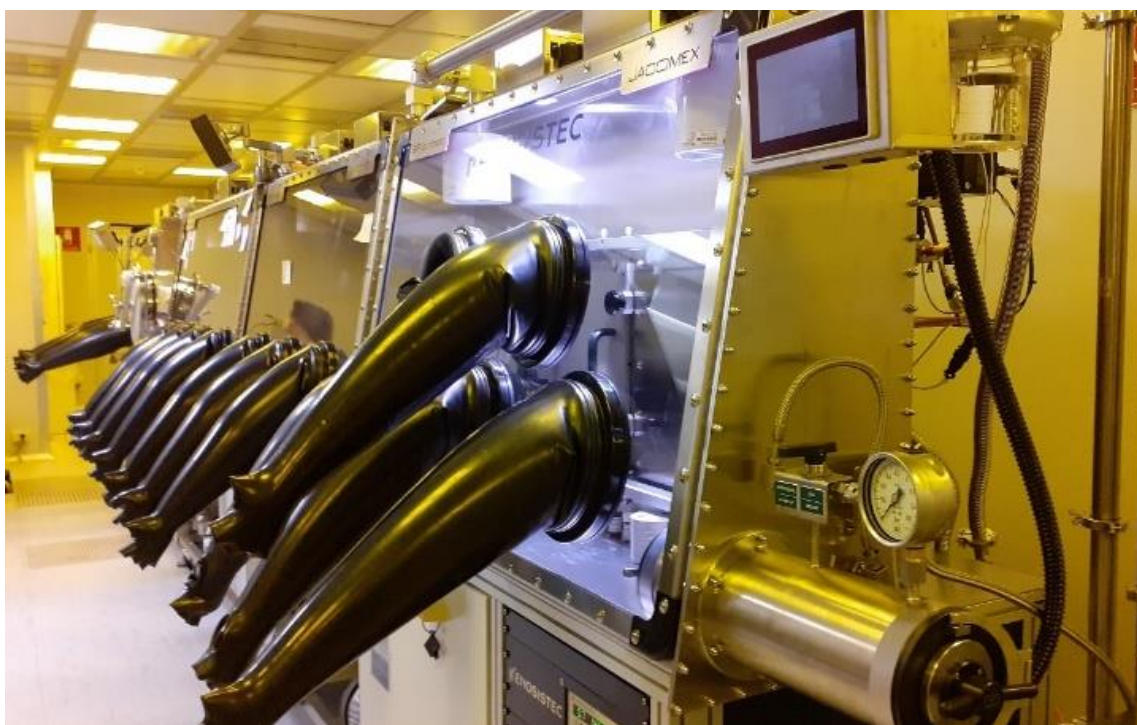
Figura 15. Foto dell'intera linea di glove box nelle camere bianche del CR ENEA di Portici, con in primo piano l'adattatore a 5 guanti del sistema di evaporazione installato (il guanto superiore sinistro si è rivelato al momento poco utile ed è stato quindi omo).
