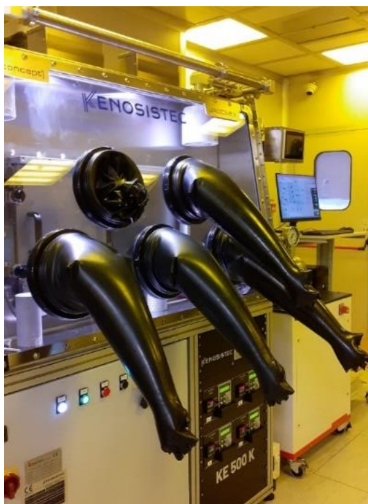
Figura 16. Foto dell'impianto installato (immagine a sinistra), con ingrandimento sul particolare del portello della camera di deposizione (immagine a destra) con accesso tramite i guanti dell'adattatore a glove box per caricamento dei substrati e dei materiali precursori nei crogioli.
