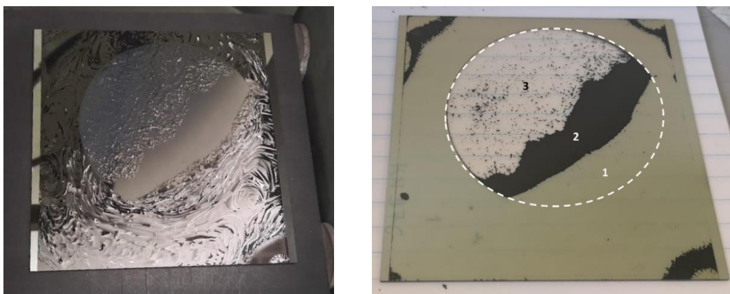
Figura 9. KN977_TRI1024 con 14 nm di NaF evaporato. Dopo solforizzazione (sinistra) il campione si delamina in gran parte della superficie.
