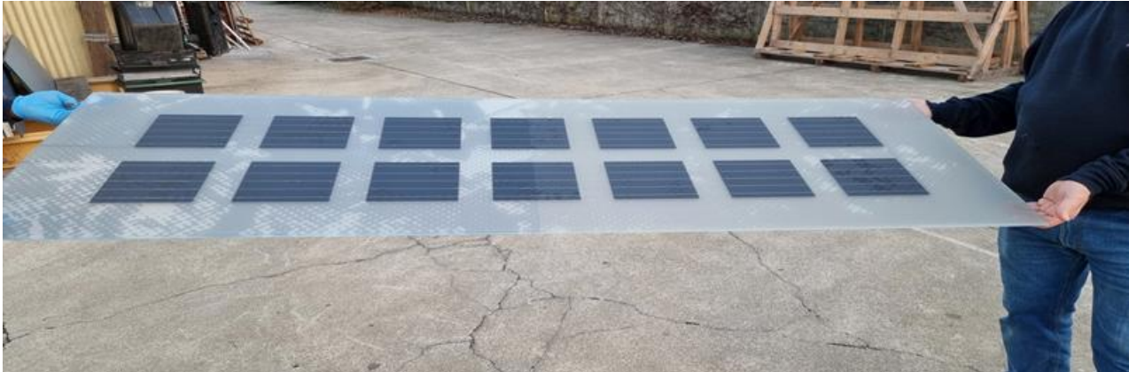
Figura 2.2.7. Il vetro fotovoltaico definitivo con il pattern realizzato da SunAge.
