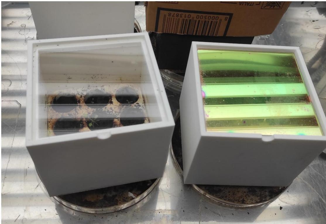
**Figura 3** i box disposti nella camera di crescita della prima sperimentazione. Si notano le pareti riflettenti nella camera di crescita.
